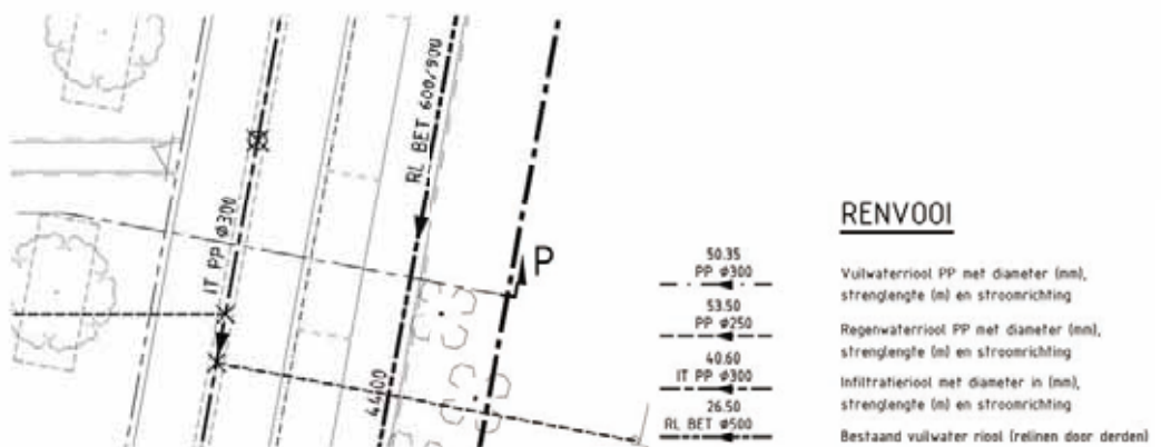
situatietekening ter plaatse van doorsnede P-P
