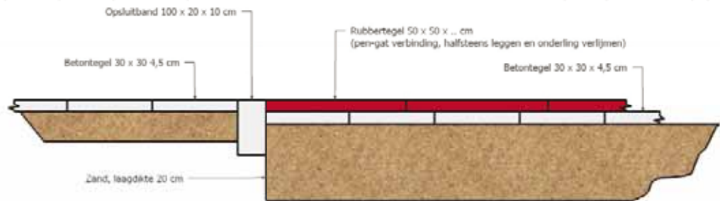
dwarsprofiel van de kantopsluiting
